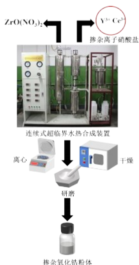
图1 超临界水热合成掺杂纳米氧化锆实验装置及流程
